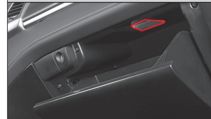
Éclairage du coffre à gants
